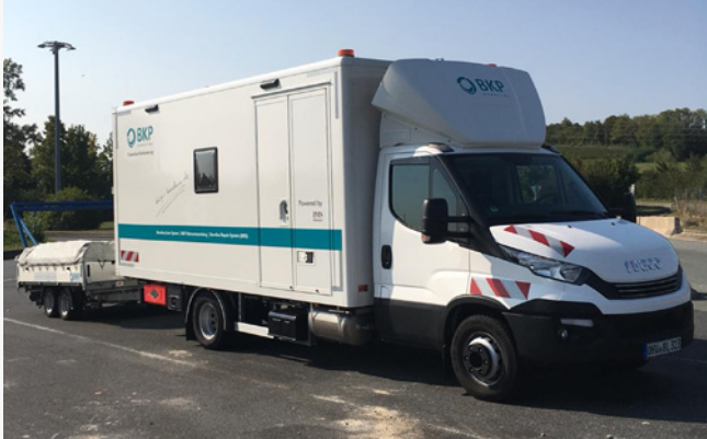
Kompakte mobile UV-Anlage mit Förderband
