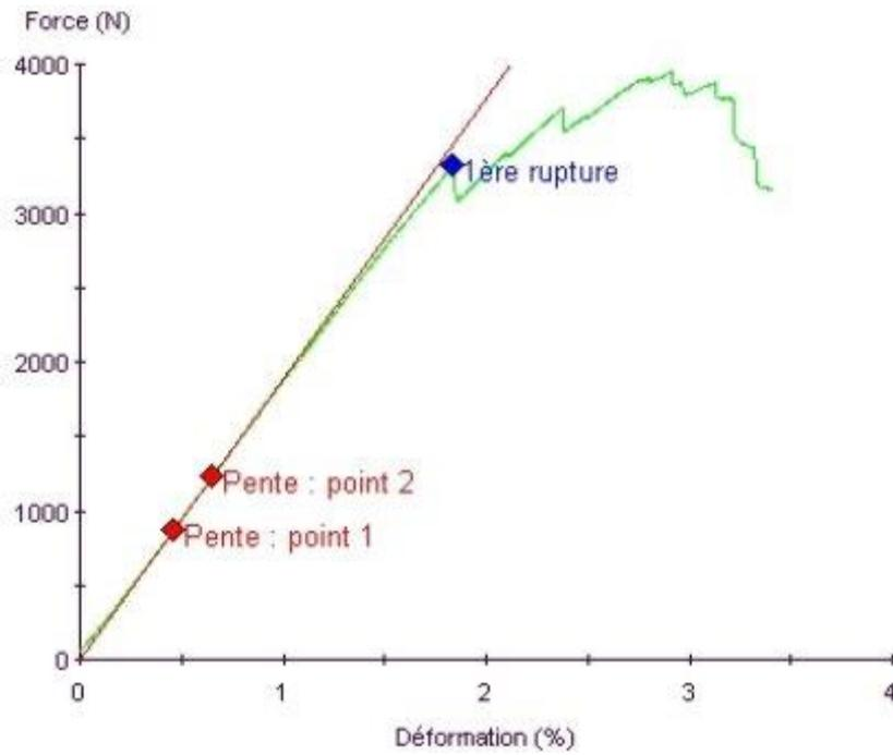
**Figure 5 – Courbe Force & déformation type d'une chemise polymérisée BEROLINA LINER ou BEROLINA HF-LINER soumis à un essai de flexion 3 points dans les conditions expérimentales de la norme NF EN ISO 11296-4 v2018 ou v2021**
