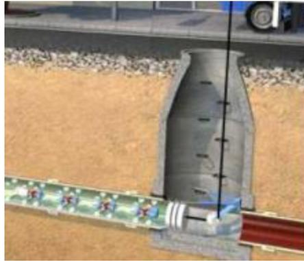
**Figure 4.4 : Mise en œuvre du train de lampes**
