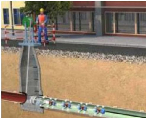
**Figure 4.5 : Traction de la chemise**
